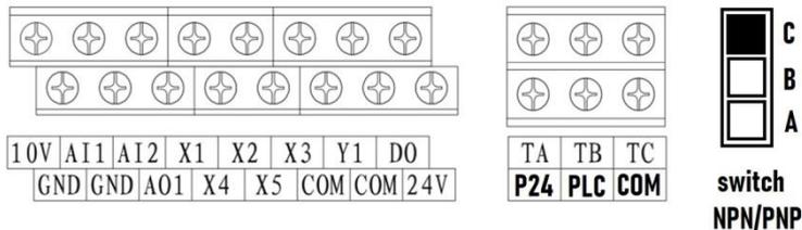
Рис. 3-10 Расположение клемм цепи управления для версии B2\_0102/0302
