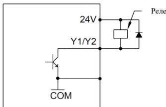
Рис. 3-16 Способ подключения внутреннего источника питания +24 В
