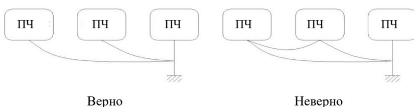
Рис. 3-5 Заземление
