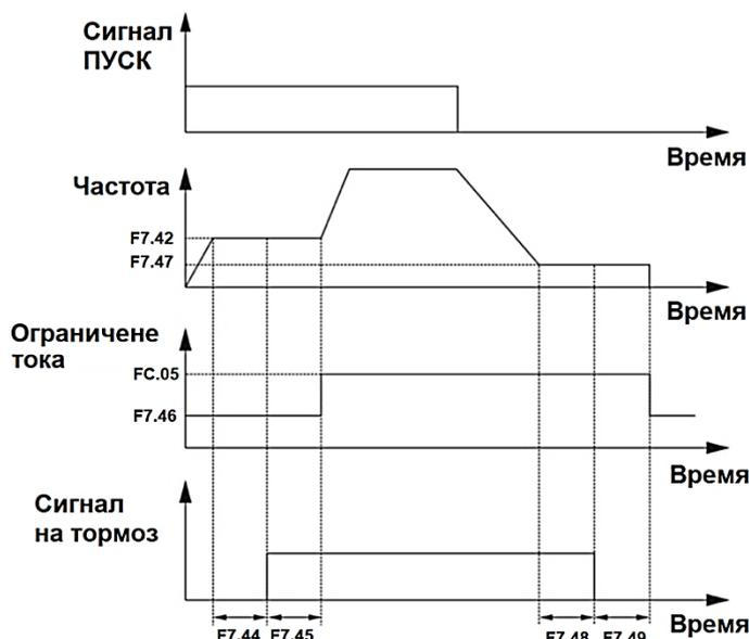
Рис. 6-23 Сигнал управления двигателем с электромеханическим тормозом
