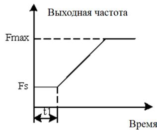
Рис.6-3 Пусковая частота и время выдержки пусковой частоты
