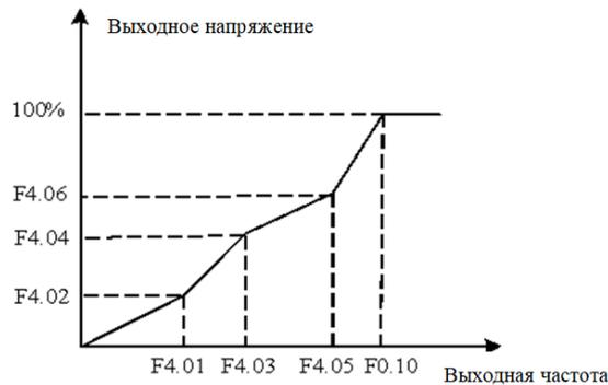
Рис.6-9 Кривая зависимости напряжения от частоты, определяемая пользователем
