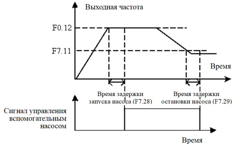
Рис. 6-22 Сигнал управления вспомогательным насосом для постоянной подачи воды под давлением
