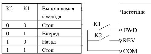
Рис.6-13 Двухпроводной режим управления 1
