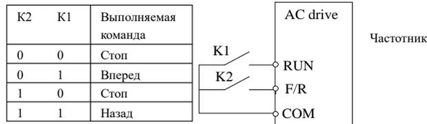
Рис. 6-14 Двухпроводной режим управления 2
