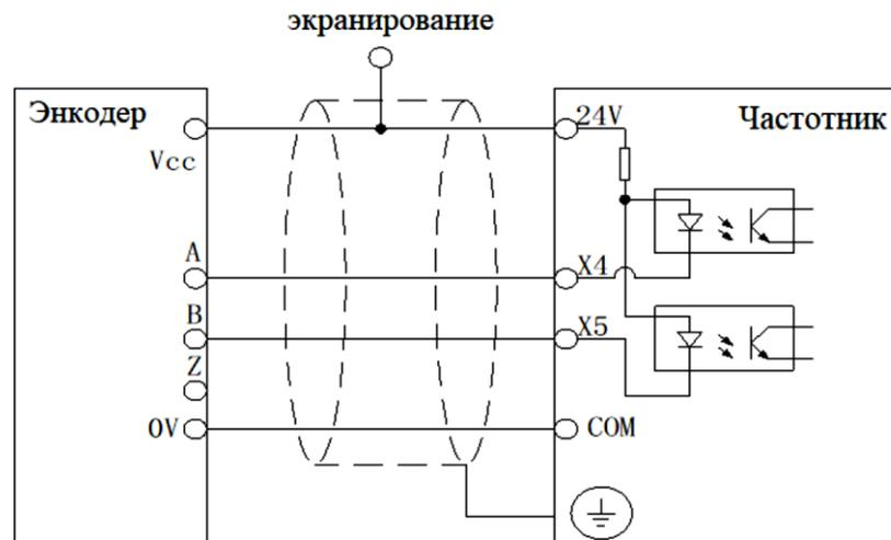
Вышеуказанная схема – это способ подключения энкодера с выходом Push-Pull или выходом по напряжению. Напряжение питания энкодера 24В и рекомендуемое питание для входной оптопары преобразователя 24В.
