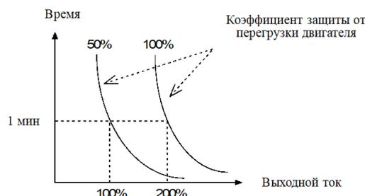
Рис. 6-28 Кривая защиты двигателя от перегрузки
