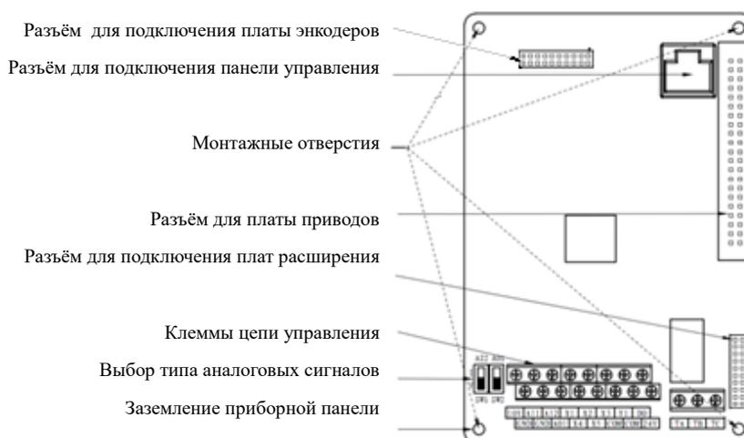
Рис. 3-21 Плата управления с возможностью подключения платы энкодеров
