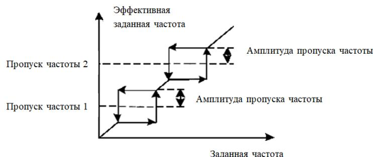
Рис. 6-5 Пропуск частот
