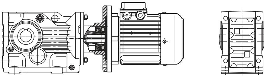
б) Редуктор **КА..В** – полый выходной вал, исполнение на лапах. Этот редуктор тоже имеет возможность установки цельного выходного вала и выходного
