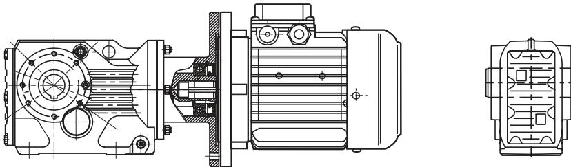
а) Редуктор **КА** – полый выходной вал, резьбовые отверстия на корпусе. Имеет возможность установки реактивной штанги, возможность установки цельного выходного вала и выходного фланца.
