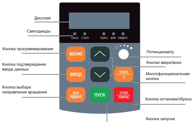
Рис. 5.2 Функции кнопок и светодиодов панели управления LCI(S)
