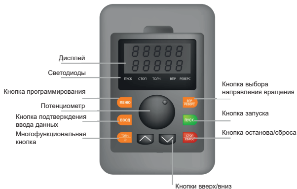
Рис. 5.1 Функции кнопок и светодиодов панели управления LCI
