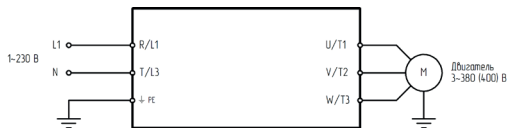
Рис. 3.2.3 Подключение силовых клемм
