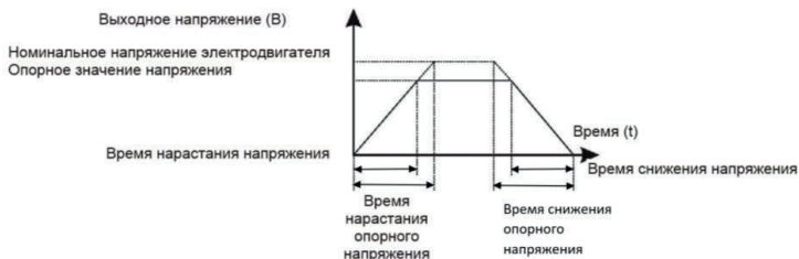
Рис.6.8 Время нарастания и снижения напряжения
