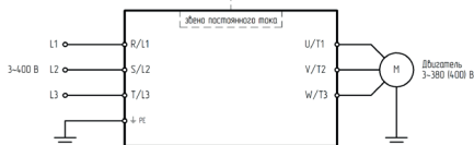
Рис. 3.2.4 Подключение силовых клемм
