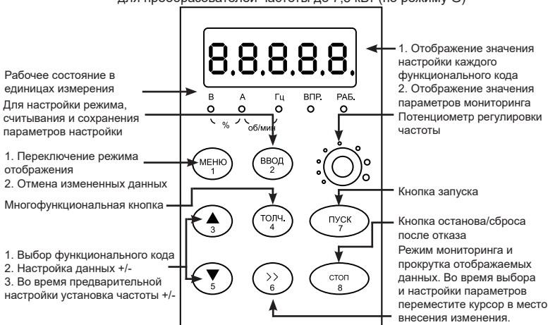
Рис. 4 – Описание панели управления FCI-KP-S
